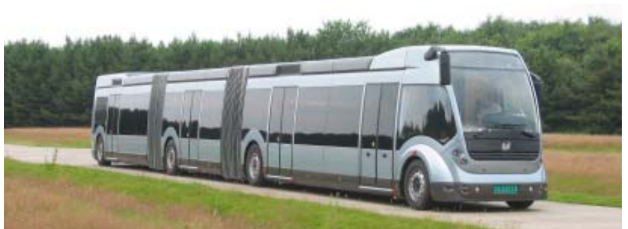
欧洲最现代、面向未来的巴士快速交通车型：斐利亚 80，它是荷兰VDL集团属下先进巴士快速交通公司所设计制造的，车长24M，已有12辆在爱恩德霍芬投入运营
