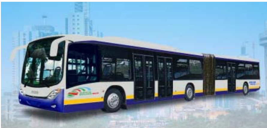
常州依维柯公司为北京南中轴巴士快速交通示范线路设计的左开门铰接式巴士效果图。车长18M, 额定乘员200人, 运行时速(满载): \leq 80\text{Km/H} , 采用环保型柴油发动机(欧III), 自动变速箱(带缓速器)、空气弹簧悬架或前空气弹簧后板簧复合式悬架、装有盘式或前盘后鼓式的制动器系统、地板高度350~400mm, 宽通道双内摆门, 门内净宽 \leq 1.0\text{M}
