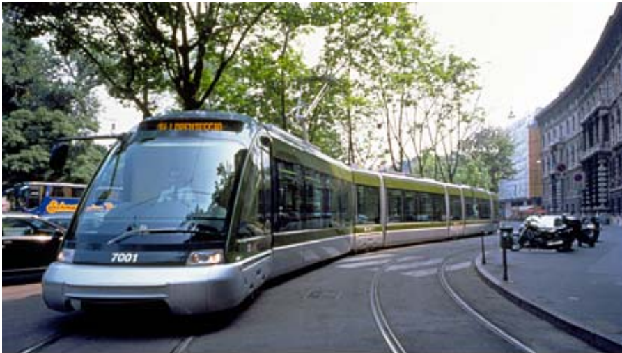
意大利米兰的现代轻轨交通车辆 许多城市巴士快速交通线路所采用的车型都具有轨道车辆的造型风格特征，流线型的车头设计，大容量的铰接式巴士，多车门，低地板方便乘客上下等特征。
