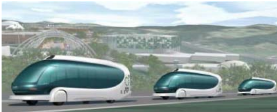
丰田汽车公司宣布，将在名古屋的2005年世界博览会上正式使用智能多模式交通系统，其先进的自动导航系统车辆采用全新公共交通理念设计理Z型密封客舱(Z-Capsule)，力求体贴包容每位乘客，造型为亲近人与环境的柔软曲线形，确保车内可以达到全景视野。车辆专用路上为无人自动驾驶，可列队行驶、自动分开/合并，在一般道路上则由驾驶员手动驾驶
