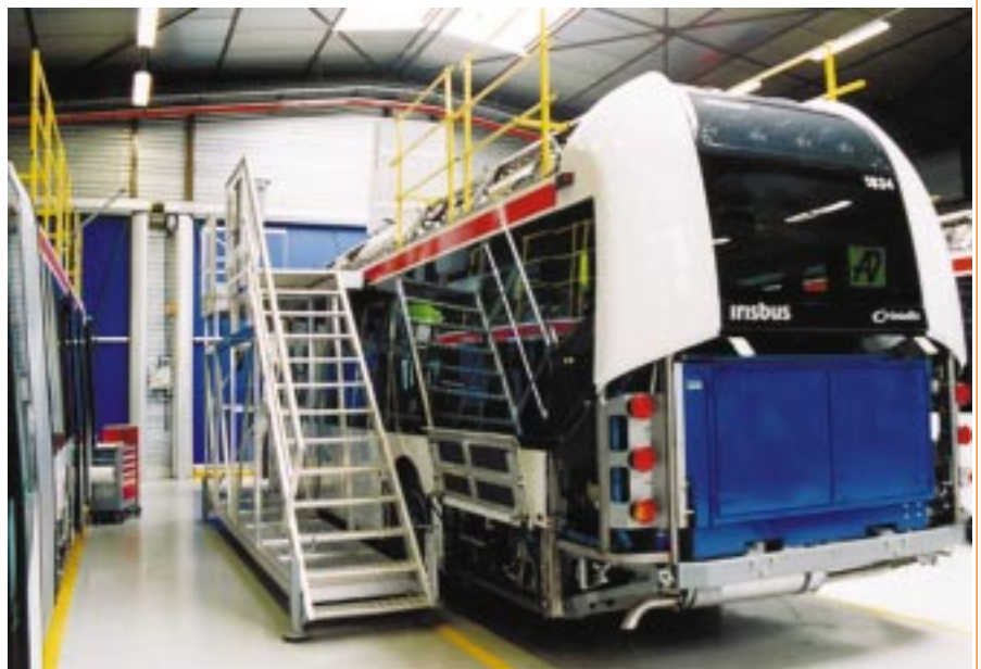
CIVIS 的大量部件安装在车顶，装配车间有许多桶架
